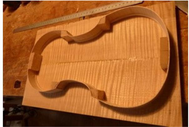
*Die Rundungen der Zargen werden mit dem Biegeapparat (unten) hergestellt.*
